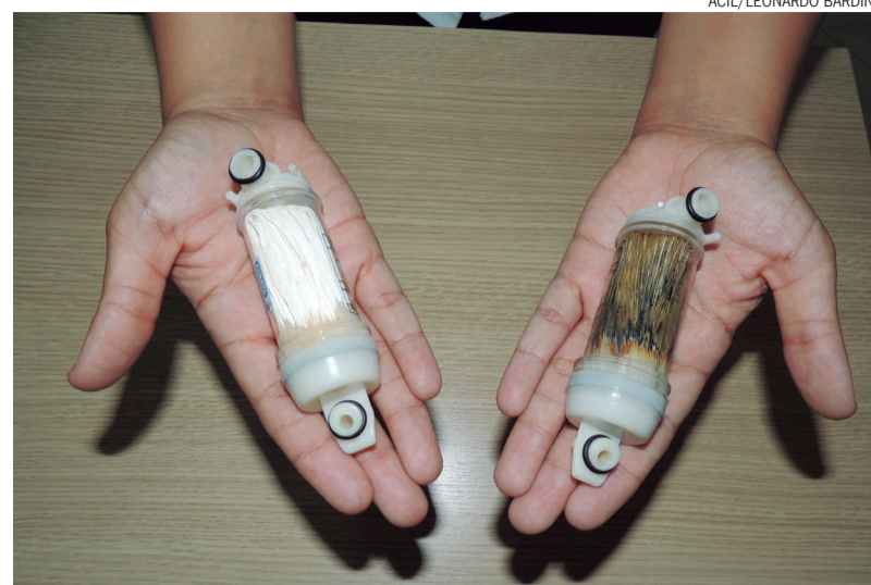
O Módulo Retentor de Bactérias (MRB) faz a limpeza de qualquer vestígio de impurezas ou materiais sólidos presentes na água
